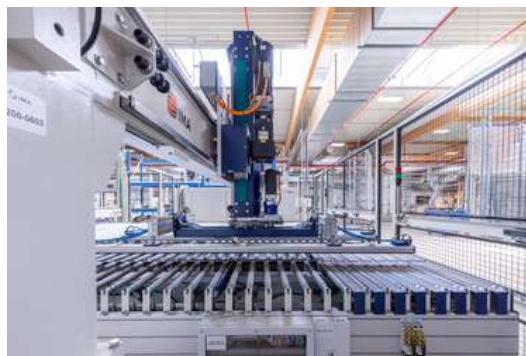
Ein Portal mit Vakuumsaugern positioniert die Holzplatten auf den Förderbändern.
