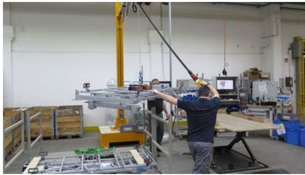
Die erste Station auf der Montage-Reise des Pflegebettes Elvido: Das Metallgestell wird auf die Hebebühne geschwenkt.
