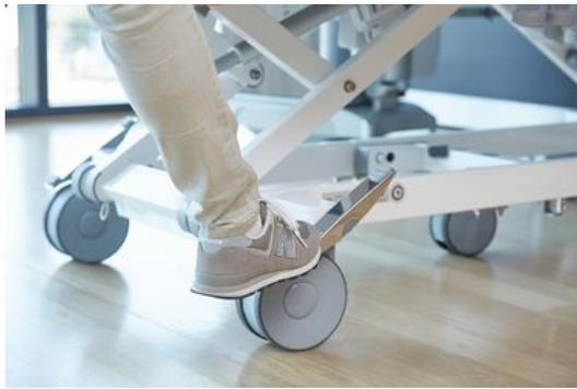
2. Um die Bremsen zu lösen, muss einer der Bremstritte wieder in die Waagerechte gebracht werden.
